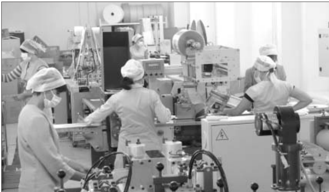
Автоматизована лінія з виробництва масок одноразових з нетканних матеріалів ТОВ «Фірма «Технокомплекс».
